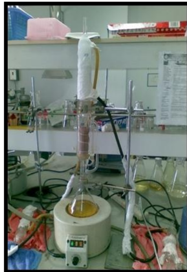
ภาพที่ 3.3 การสกัดน้ำมันหอมระเหยด้วยเฮกเซนโดยใช้เครื่องซอกซ์เลต
